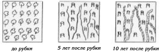
Рис. 2. Образование линий эрозий и постепенное разрастание.
